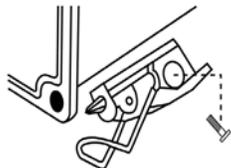
Los controles se envían con un tornillo y una tuerca para mantener cerrado el pestillo de desenganche rápido. Usted puede remover el tornillo y la tuerca durante el proceso de instalación para protegerlo contra exposición accidental al alto voltaje dentro del gabinete.
